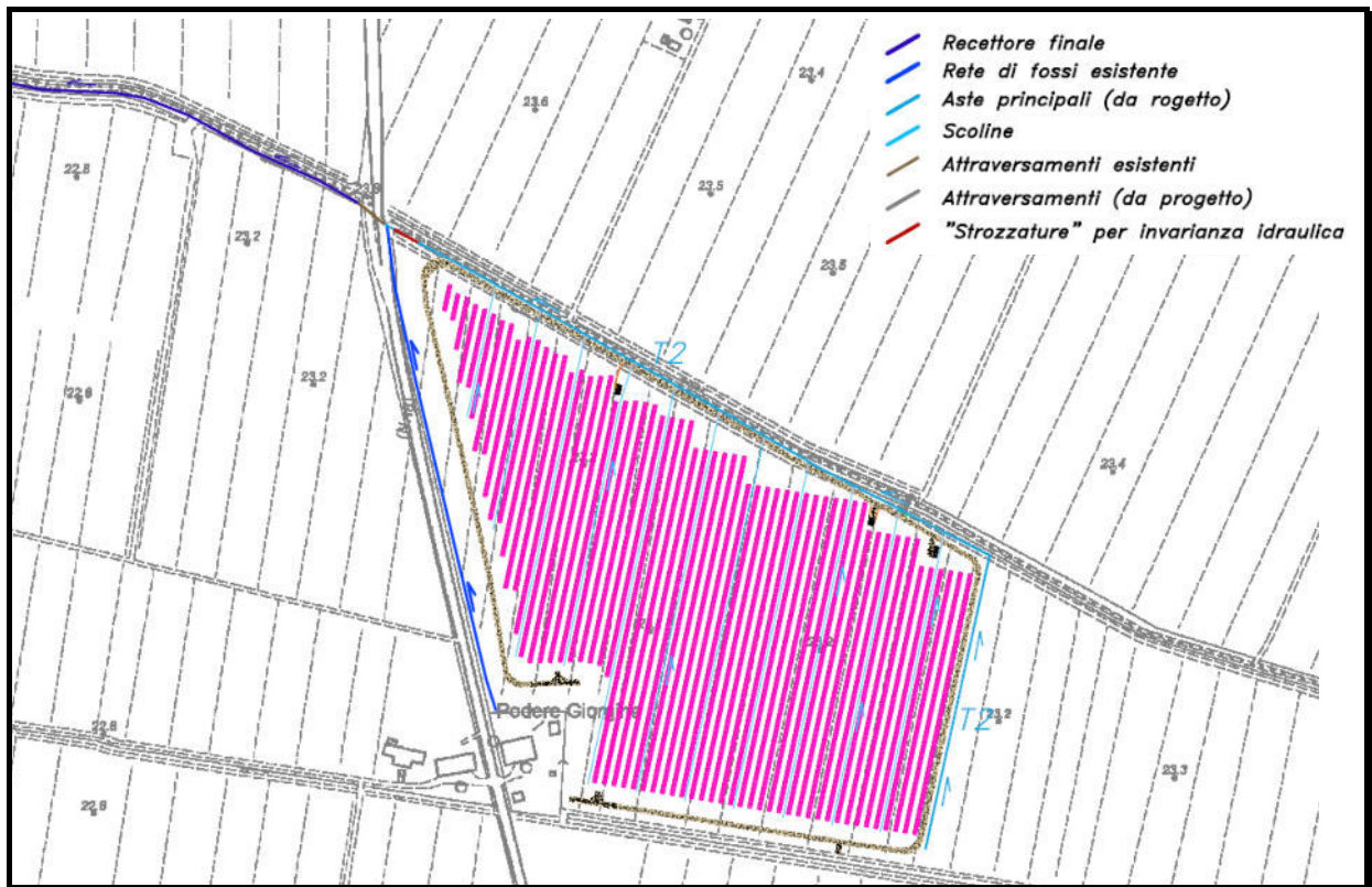
Figura 20: rete scolante di progetto – Campo B.
